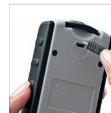
Aufladung über USB-Ladekabel mit Micro-USB-Anschluss
