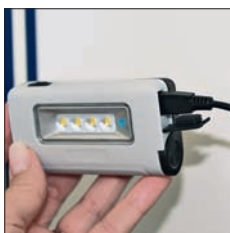
Aufladung über USB-Ladekabel mit Micro-USB-Anschluss
