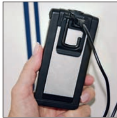
Aufladung über USB-Ladekabel mit Micro-USB-Anschluss
